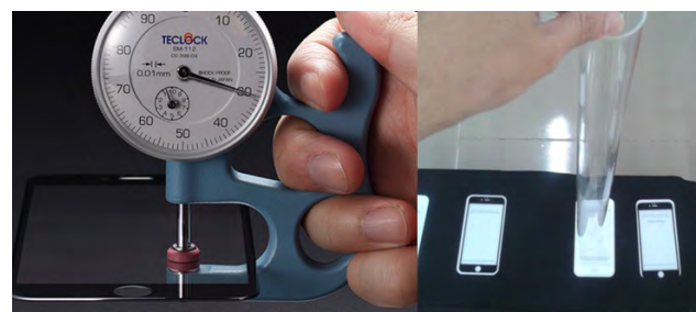
圖 2：產品厚度降至 0.33±0.05mm，落球未破裂
